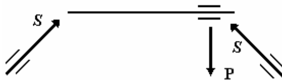
Рис. 4 – Дія сил при симетричному розташуванні колісної пари.
